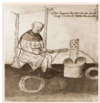
Волочение проволоки на приспособлении с качающимся сиденьем.
